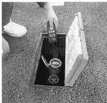
東京水道サービスが 開発した小型の漏水 発見器
